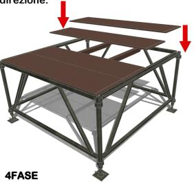
Inserire profilo di alluminio per fissare i pannelli alla struttura. Il bloccaggio avviene tramite perno a brugola brevettato da ILMA. Si opera n corrispondenza del piano di calpestio.
