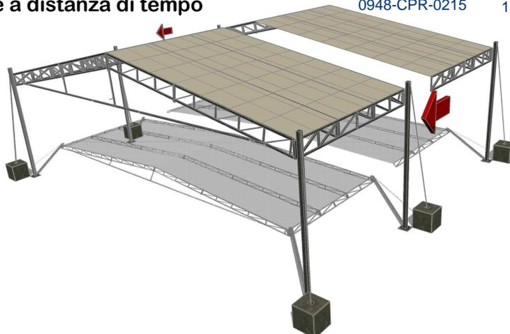
Il capannone EUROPA è un a struttura prefabbricata realizzata in tubolari e tubi acciaio S235JR zincato a caldo, e tamponamenti in PVC
